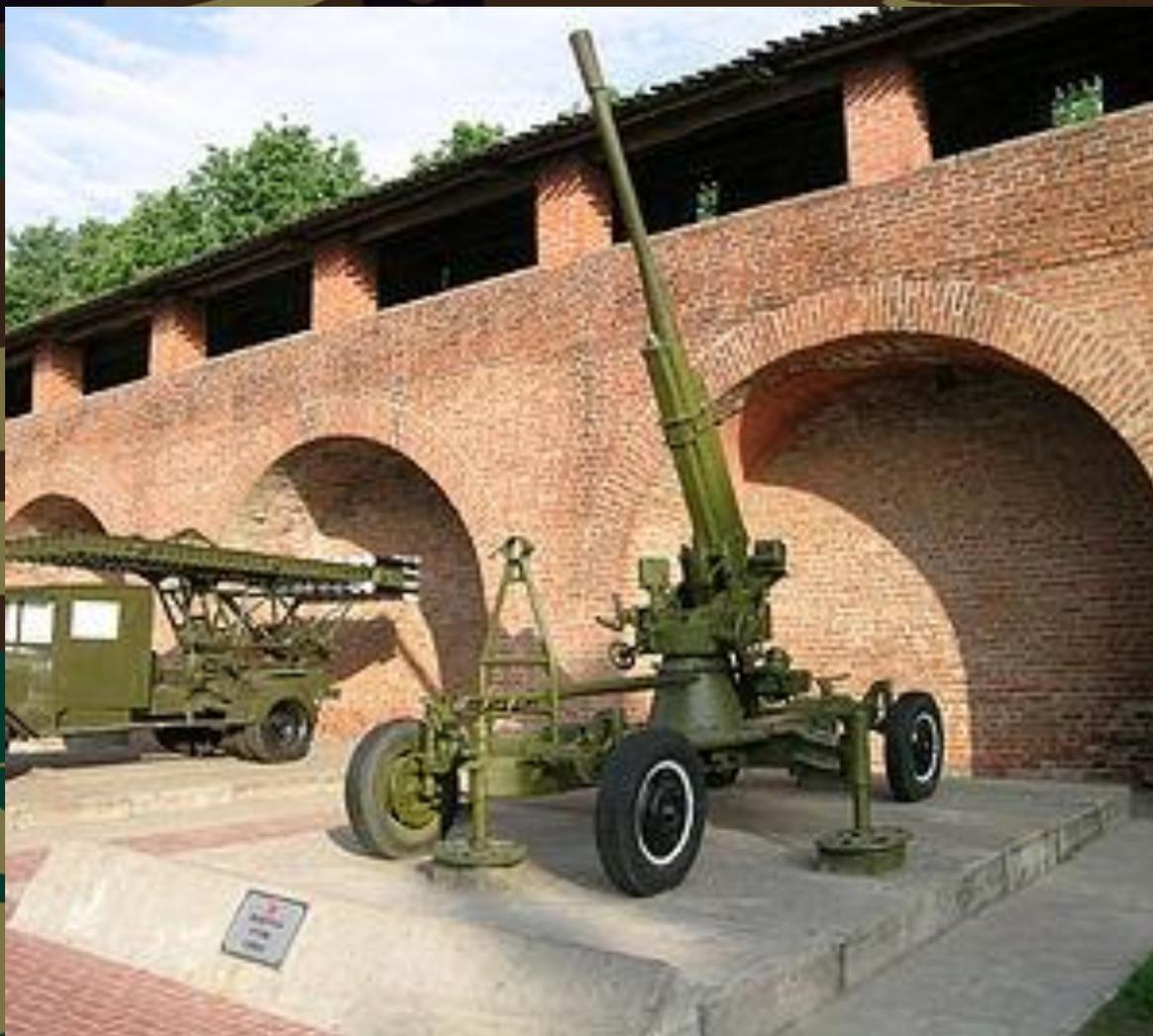
85-мм зенитная пушка образца 1939 года (52-К). В первые годы войны в условиях нехватки противотанковых пушек, 85-мм зенитная пушка использовалась для стрельбы по танкам из-за высокой начальной скорости снаряда (800 м/сек) и его большого веса (9,2 кг). Установлена в Нижегородском Кремле.
